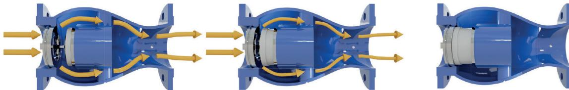
Cuando el flujo circula en la dirección prevista, el muelle se comprime en consecuencia, permitiendo la apertura total de la válvula. El cuerpo en forma de aguja garantiza la máxima resistencia a la cavitación y al ruido, al tiempo que minimiza la pérdida de carga.
