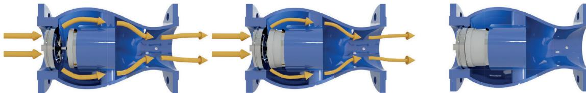
Quando il flusso procede nella direzione prevista, la molla si comprime, consentendo la completa apertura del passaggio della valvola. Il corpo a forma di ago garantisce la massima resistenza alla cavitazione e al rumore, riducendo al minimo la perdita di carico.
