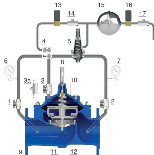
válvula y reducir el caudal. Las válvulas de aguja 14 y 17 y el depósito 15 aumentan la estabilidad de la válvula durante el ajuste. El flujo hacia y desde la cámara principal (10) se controla mediante la exclusiva unidad de control PF GR.I.F.O. (4), lo que hace que las velocidades de apertura y cierre de la válvula sean independientes entre sí.
