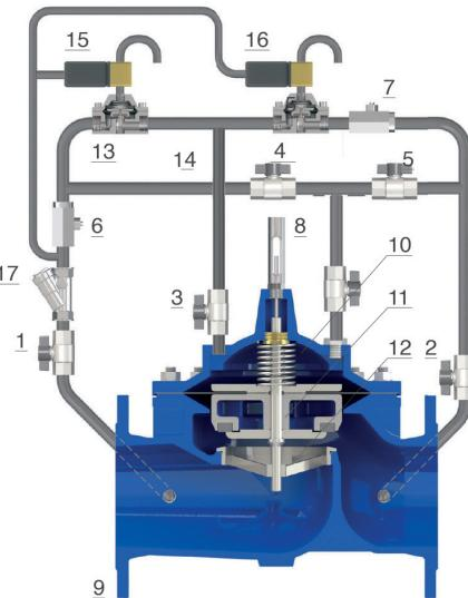
están en funcionamiento debido a un corte de corriente. Un filtro (17), instalado aguas arriba, también protege el solenoide y otros componentes del circuito del contacto con impurezas y residuos.
