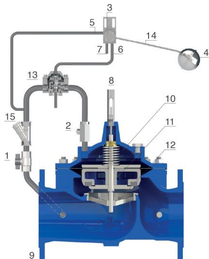
nicación con la atmósfera. Como resultado, el tapón (11) se levanta, permitiendo que el flujo pase a través del asiento (12). La válvula de aguja PF (2) regula el caudal de entrada y salida de la cámara para evitar picos de presión durante el cierre.
