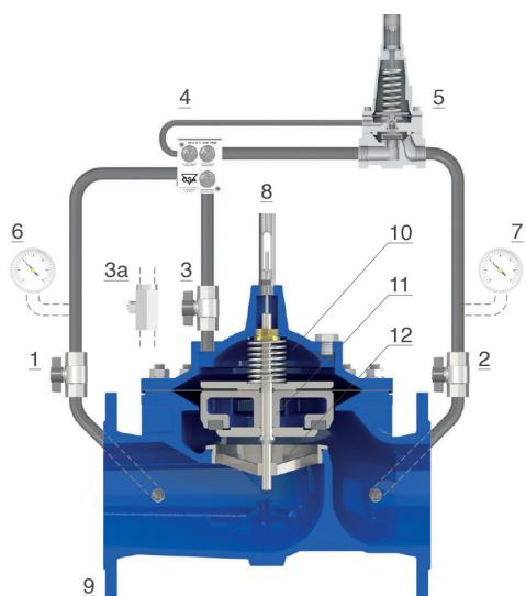
GR.I.F.O. (4), equipado con un filtro y tres válvulas de aguja ajustables, necesarias para garantizar la estabilidad y hacer que las velocidades de apertura y cierre de la válvula sean independientes entre sí.
