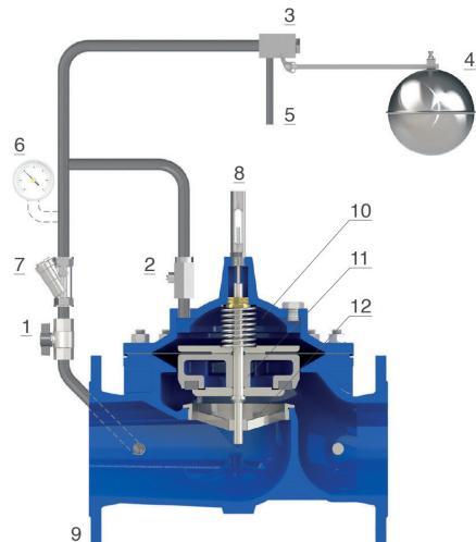
del filtro (7) hay un orificio fijo, indispensable para el buen funcionamiento del circuito hidráulico. La válvula de aguja (2) regula el caudal de entrada y salida de la cámara (10) para evitar golpes de ariete durante el cierre.
