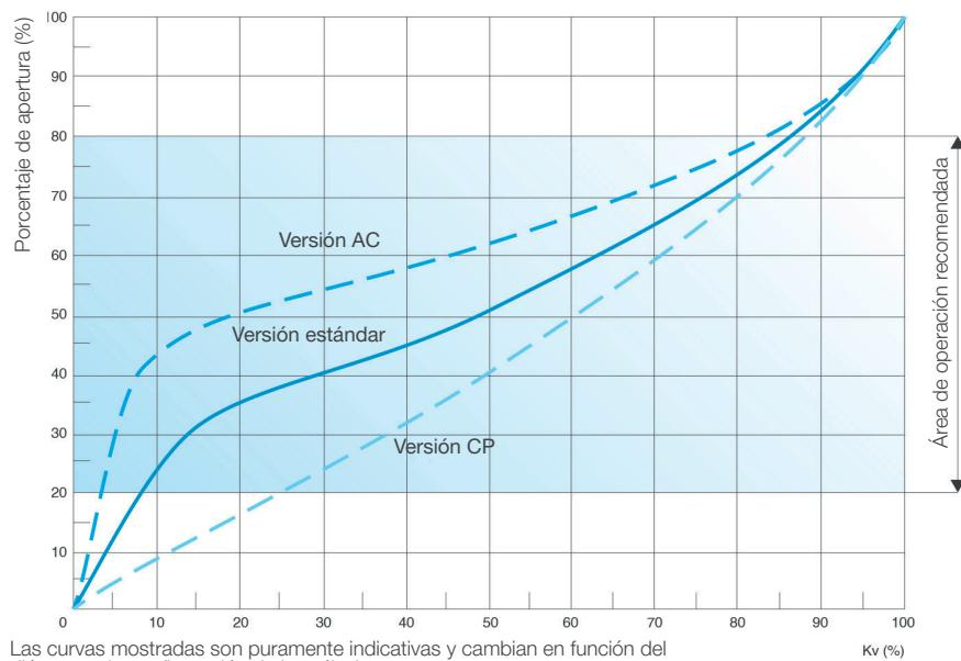
Las curvas mostradas son puramente indicativas y cambian en función del diámetro y la configuración de las válvulas.
