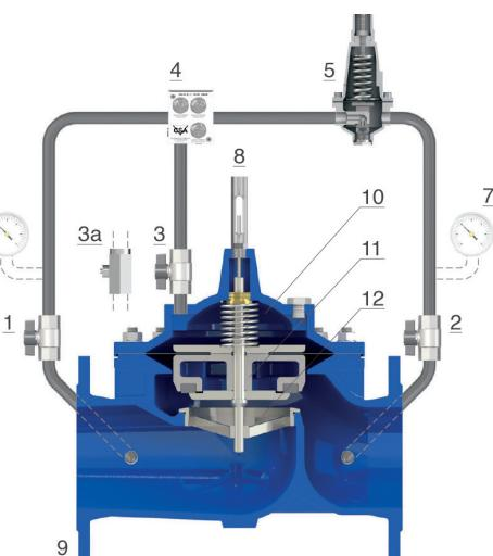
para garantizar la estabilidad y hacer que las velocidades de apertura y cierre de la válvula sean independientes entre sí. Gracias a las válvulas de bola (1, 2 y 3), el mantenimiento del circuito y de sus componentes también puede realizarse sin interrumpir el flujo a través de la válvula principal.
