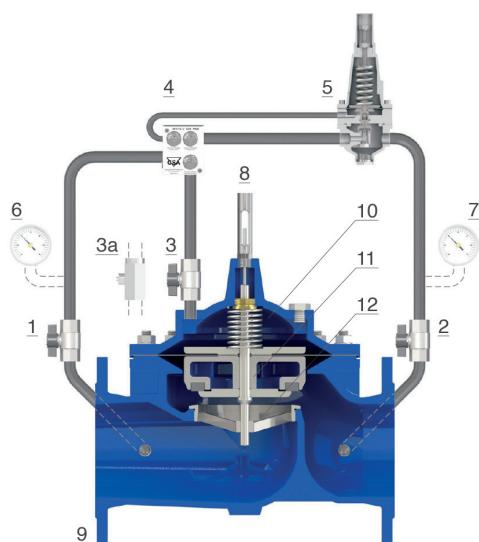
es controlada por la unidad de control PF GR.I.F.O.. (4), equipado con un filtro y tres válvulas de aguja ajustables, necesarias para garantizar la estabilidad y hacer que las velocidades de apertura y cierre de la válvula sean independientes entre sí.
