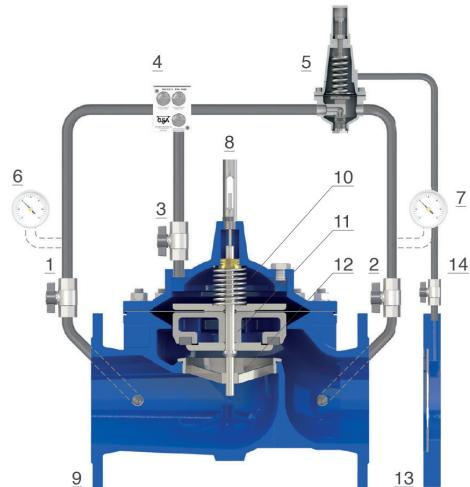
de la cámara principal (10) está controlado por la unidad de control PF GR.I.F.O.. (4), equipado con un filtro y tres válvulas de aguja ajustables, que garantizan la estabilidad y hacen que las velocidades de apertura y cierre de la válvula sean independientes.
