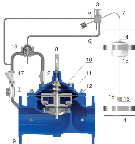
momento en el que el flotador (15) se apoya en el tope inferior (16), girando la palanca (7) hacia abajo. Esto hace que la presión en la cámara de control (10) se descargue en la atmósfera, con lo que el tapón (11) sube y el flujo se reanuda a través del asiento (12).
