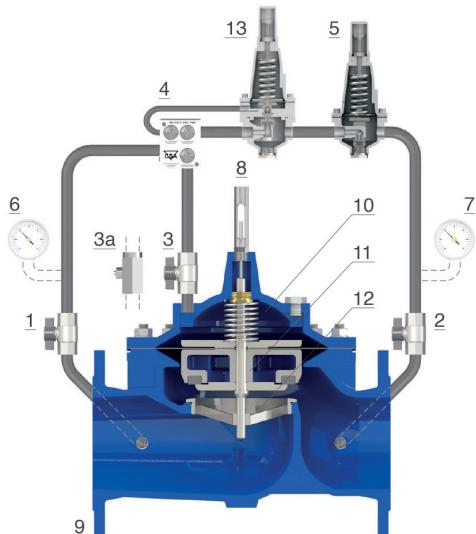
válvulas de aguja ajustables, necesarias para garantizar la estabilidad y hacer que las velocidades de apertura y cierre de la válvula sean independientes entre sí. Gracias a las válvulas de bola (1, 2 y 3), el mantenimiento del circuito y de sus componentes también puede realizarse sin interrumpir el flujo a través de la válvula principal.
