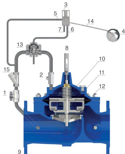
mosfera. Di conseguenza, l'otturatore (11) si solleva, permettendo il passaggio del flusso attraverso la sede (12). La valvola a spillo PF (2) regola il flusso in ingresso e in uscita dalla camera, per prevenire sbalzi di pressione durante la chiusura.
