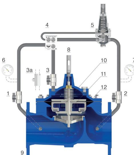
provista di filtro e tre valvole a spillo regolabili, necessarie per garantire la stabilità e rendere le velocità di apertura e chiusura della valvola indipendenti fra loro.
