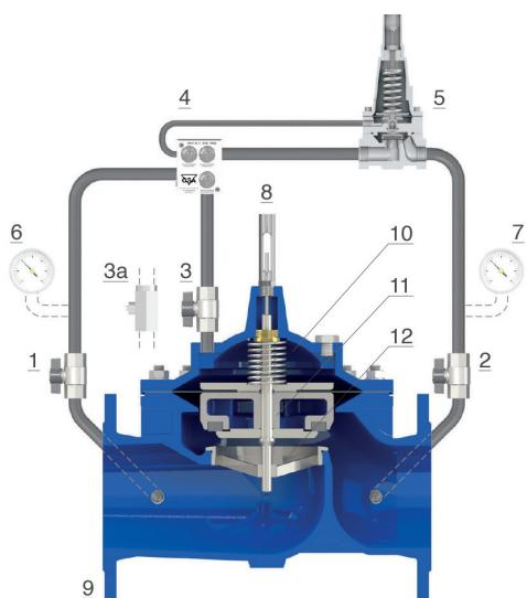
unità di regolazione GR.I.F.O. (4), provvista di filtro e tre valvole a spillo regolabili, necessarie per garantire la stabilità e rendere le velocità di apertura e chiusura della valvola indipendenti fra loro.
