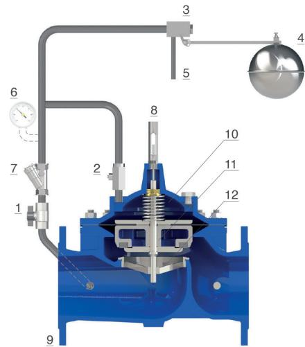
terno del filtro (7) è presente un orifizio fisso, indispensabile per il corretto funzionamento del circuito idraulico. La valvola a spillo (2) regola il flusso in ingresso e in uscita dalla camera (10), per prevenire sbalzi di pressione durante la chiusura.
