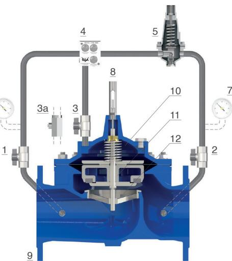
e rendere le velocità di apertura e chiusura della valvola indipendenti fra di loro. Grazie alle valvole a sfera (1, 2 e 3), inoltre, la manutenzione del circuito e dei suoi componenti può essere effettuata senza interrompere il flusso attraverso la valvola principale.
