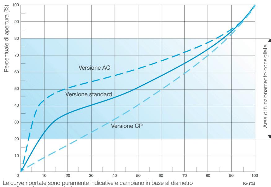
Le curve riportate sono puramente indicative e cambiano in base al diametro e configurazione delle valvole.
