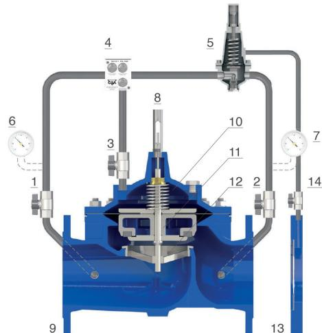
in ingresso e in uscita dalla camera principale (10) è controllato dall'unità di regolazione PF GR.I.F.O. (4), provista di filtro e tre valvole a spillo regolabili, che garantiscono la stabilità e rendono le velocità di apertura e chiusura della valvola indipendenti.
