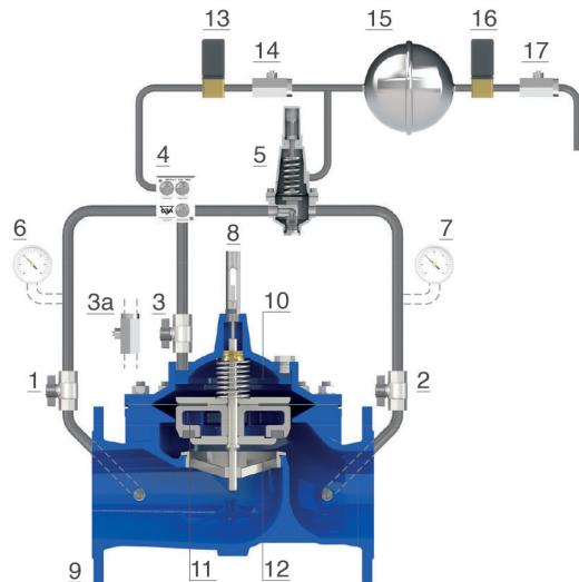
ed il serbatoio 15 aumentano la stabilità della valvola in fase di regolazione. Il flusso verso e dalla camera principale (10) è controllato dall'esclusiva unità di regolazione PF GR.I.F.O. (4), che rende le velocità di apertura e chiusura della valvola fra loro indipendenti.
