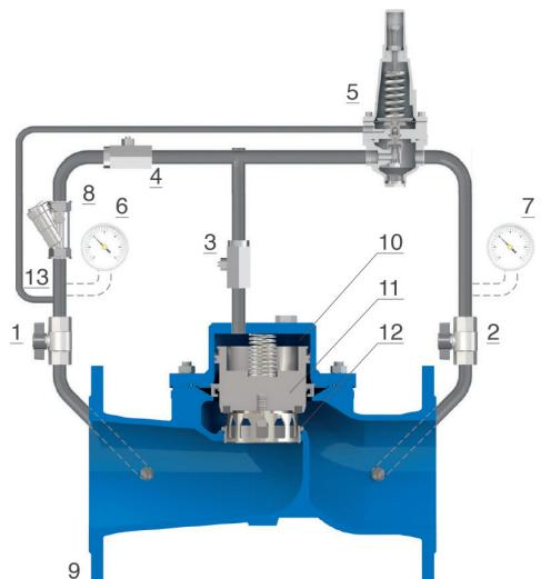
caso de cambios rápidos del caudal. Gracias a la válvula de aguja (3) y a las válvulas de bola (1 y 2), el mantenimiento del circuito y de sus componentes también puede realizarse sin interrumpir el flujo a través de la válvula principal.
