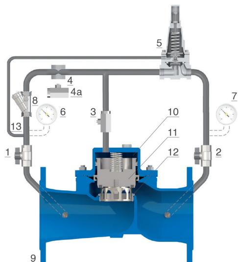
caso de cambios rápidos del caudal. Gracias a la válvula de aguja (3) y a las válvulas de bola (1 y 2), el mantenimiento del circuito y de sus componentes también puede realizarse sin interrumpir el flujo a través de la válvula principal.
