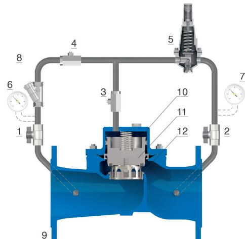
la precisión incluso en caso de cambios rápidos del caudal. Gracias a la válvula de aguja (3) y a las válvulas de bola (1 y 2), el mantenimiento del circuito y de sus componentes también puede realizarse sin interrumpir el flujo a través de la válvula principal.
