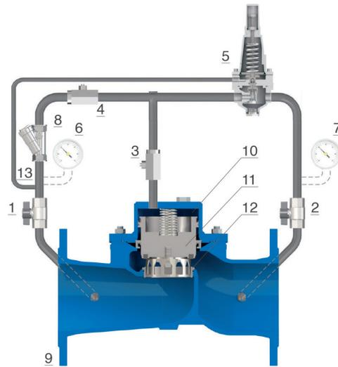
anche in caso di rapide variazioni di portata. Grazie alla valvola a spillo (3) e alle valvole a sfera (1 e 2), inoltre, la manutenzione del circuito e dei suoi componenti può essere effettuata senza interrompere il flusso attraverso la valvola principale.
