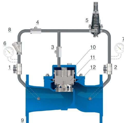
di portata. Grazie alla valvola a spillo (3) e alle valvole a sfera (1 e 2), inoltre, la manutenzione del circuito e dei suoi componenti può essere effettuata senza interrompere il flusso attraverso la valvola principale.
