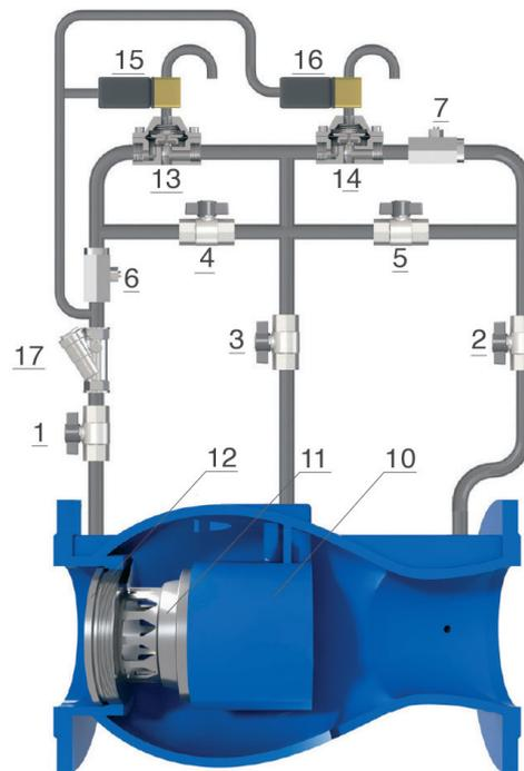
filtro (17), instalado aguas arriba, protege el solenoide y los demás componentes del circuito del contacto con impurezas y residuos.
