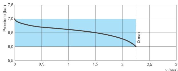
**Sensibilidad del regulador** La curva de la figura muestra la variación indicativa de la presión real en el tramo posterior con respecto al valor configurado en función del aumento del caudal. Se indican la velocidad máxima y las condiciones de trabajo recomendadas (zona azul).
