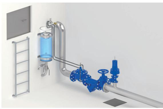
**Controllo del livello.** Nelle installazioni con valvole automatiche per il controllo del livello in serbatoio, in particolare quando si gestiscono i livelli minimo e massimo, esiste un rischio significativo di sovrappressione durante la fase di chiusura della valvola.
