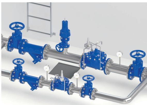
**Organi di sezionamento rapido.** Posizionata a monte di organi di sezionamento rapido, quali ad esempio le idrovalvole H-VAL, la valvola previene l'aumento di pressione a seguito di un arresto repentino della colonna di fluido. In queste installazioni si consiglia di introdurre a valle e a monte anche sfiati a triplice effetto anti-colpo d'ariete del modello WAVE o WAVE LITE 3S AWH.
