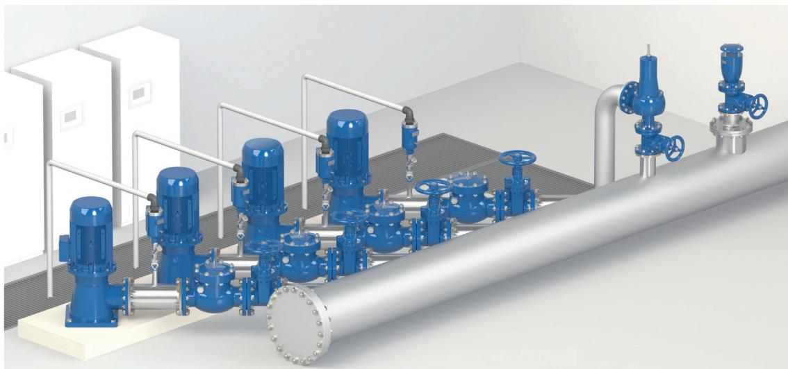
**Grupos de reducción.** Situada en el tramo posterior de un grupo de reducción, la válvula protege la tubería principal de aumentos incontrolados de presión. La instalación incluye la válvula reductora de presión H-VAL 310/410, un bypass para el mantenimiento y purgadores antigolpe de ariete WAVE o WAVE LITE 3S AWH en el tramo anterior y posterior.
