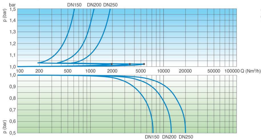
CAUDAL DE AIRE DE ENTRADA PARA EL VACIADO DE LA TUBERÍA
