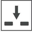
**Versión solo admisión IO**, disponible para modelos de doble función 2S y 3S. Esta variante está diseñada para permitir la instalación de la ventosa en puntos críticos del trazado en los que, por razones de diseño, debe evitarse la salida de aire. Debe tenerse en cuenta que, cuando se utiliza la versión IO, la ventosa no proporciona ninguna protección contra la sobrepresión causada por el llenado de la tubería.
