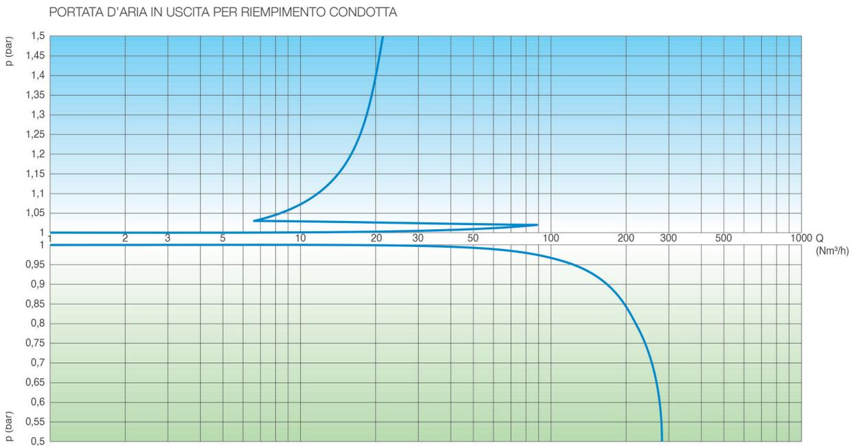
Le curve delle portate sono ottenute in Kg/s da prove di laboratorio e analisi numeriche, senza filtro, e convertite in Nm<sup>3</sup>/h applicando un fattore di sicurezza.
