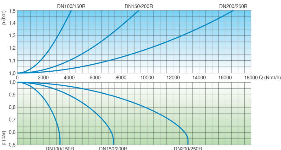
Le curve delle portate sono state ottenute in Kg/s, da prove di laboratorio e analisi numeriche, e convertite in Nm/h applicando un fattore di sicurezza.
