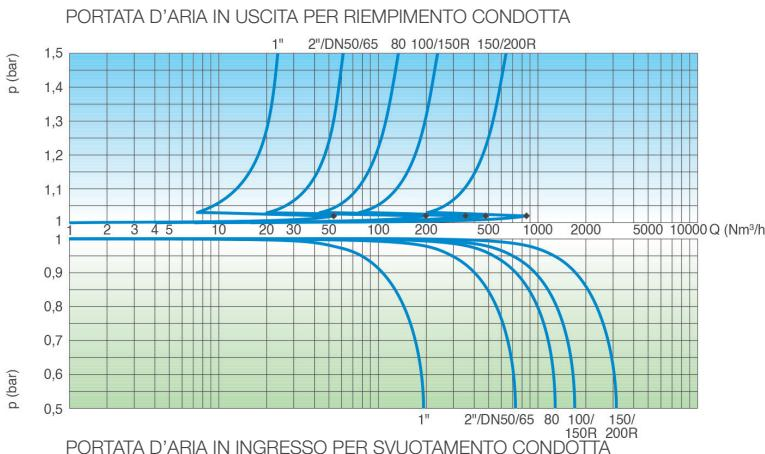
Le curve delle portate sono ottenute in Kg/s da prove di laboratorio e analisi numeriche, senza filtro, e convertite in Nm/h applicando un fattore di sicurezza.
