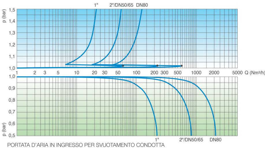
PORTATA D'ARIA IN USCITA PER RIEMPIMENTO CONDOTTA
