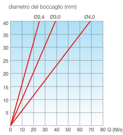
Le curve delle portate sono ottenute in Kg/s da prove di laboratorio e analisi numeriche, senza filtro, e convertite in Nm<sup>3</sup>/h applicando un adeguato fattore di sicurezza.
