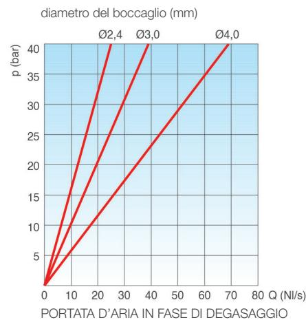
Le curve delle portate sono ottenute in Kg/s da prove di laboratorio e analisi numeriche, senza filtro, e convertite in Nm<sup>3</sup>/h applicando un adeguato fattore di sicurezza.
