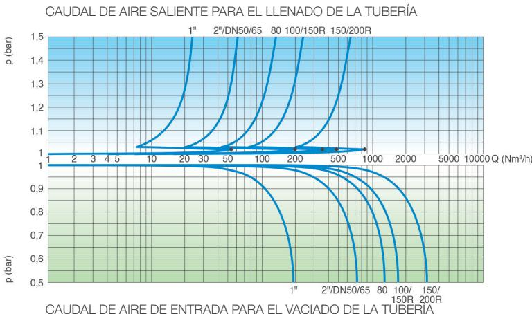
Las curvas de caudal se obtienen en Kg/s a partir de ensayos de laboratorio y análisis numéricos, sin filtrar, y se convierten a Nm/h aplicando un factor de seguridad.
