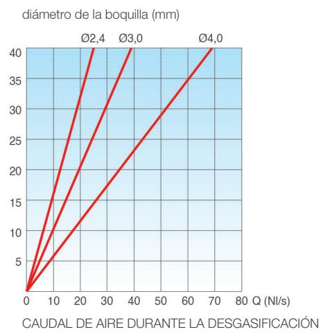
Las curvas de caudal se obtienen en Kg/s a partir de ensayos de laboratorio y análisis numéricos, sin filtrar, y se convierten a Nm<sup>3</sup>/h aplicando un factor de seguridad adecuado.
