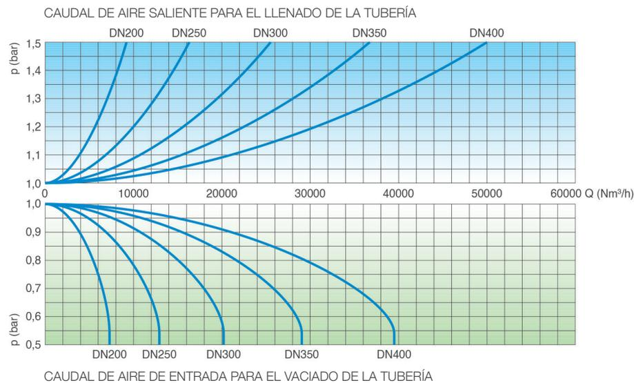
Las curvas de caudal se obtienen en Kg/s a partir de ensayos de laboratorio y análisis numéricos, sin filtrar, y se convierten a Nm<sup>3</sup>/h aplicando un factor de seguridad adecuado.
