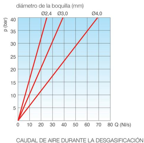
Las curvas de caudal se obtienen en Kg/s a partir de ensayos de laboratorio y análisis numéricos, sin filtrar, y se convierten a Nm<sup>3</sup>/h aplicando un factor de seguridad adecuado.
