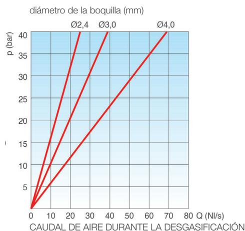
Las curvas de caudal se obtienen en Kg/s a partir de ensayos de laboratorio y análisis numéricos, sin filtrar, y se convierten a Nm<sup>3</sup>/h aplicando un factor de seguridad adecuado.
