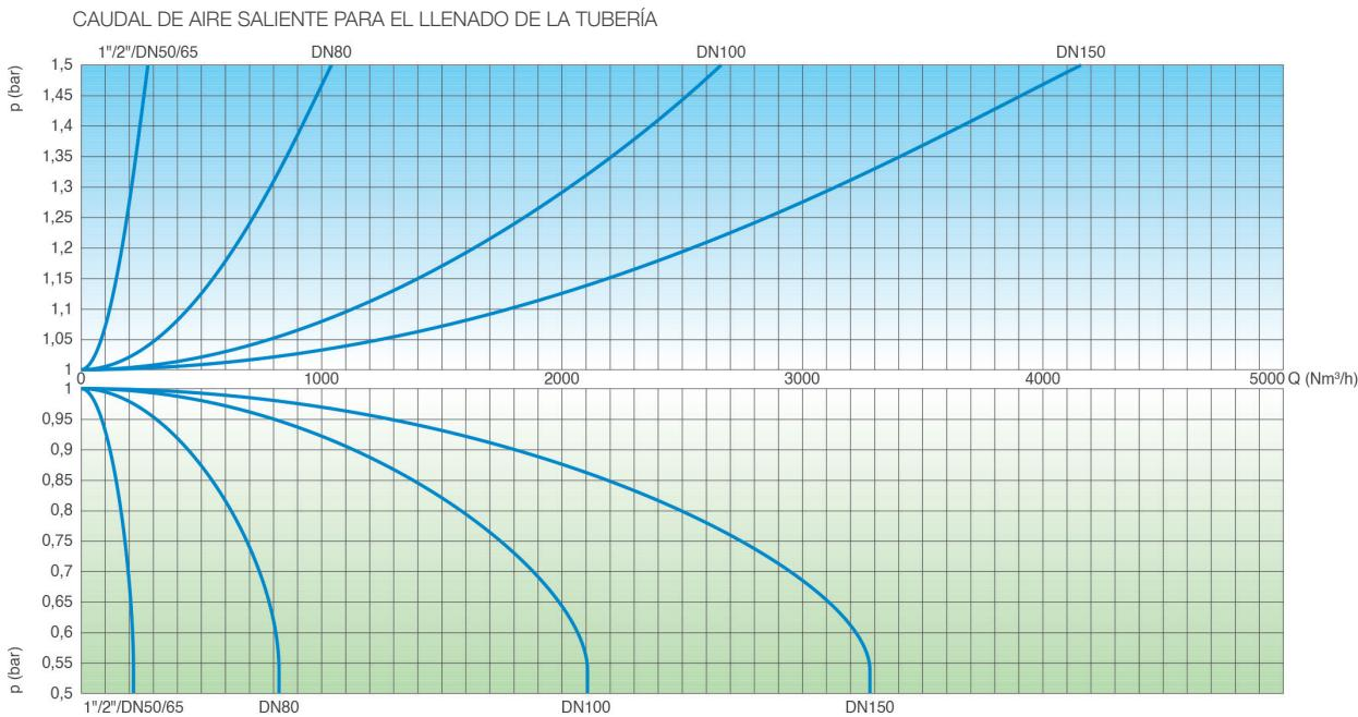
Las curvas de caudal se obtienen en Kg/s a partir de ensayos de laboratorio y análisis numéricos, sin filtrar, y se convierten a Nm<sup>3</sup>/h aplicando un factor de seguridad.
