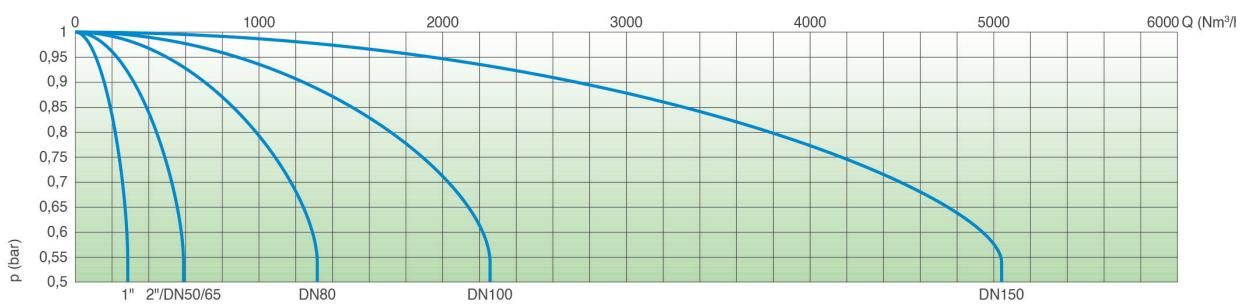
CAUDAL DE AIRE DE ENTRADA PARA EL VACIADO DE LA TUBERÍA
