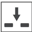
**Versión IO solo admisión**, disponible para el modelo de dos funciones WAVE HP 2S. Esta variante está diseñada para permitir la instalación de la ventosa en puntos críticos de la distribución en los que, por razones de diseño, debe evitarse la descarga de aire. Debe tenerse en cuenta que, cuando se utiliza la versión IO, la ventosa no proporciona ninguna protección contra la sobrepresión causada por el llenado de la tubería.
