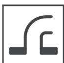
**Versione SUB**, con scarico convogliato di serie sul DN 50/65, disponibile su richiesta per i modelli SWV 3S-AWH e SWV 2S-AWH con DN maggiori. Collegato ad un tubo d'uscita, lo sfiato può operare anche in caso di allagamento del pozzetto o del sito di installazione, senza il rischio d'ingresso d'acqua contaminata nella condotta. Altro vantaggio della versione SUB è quello di evitare la fuoriuscita d'acqua durante la chiusura rapida dello sfiato.
