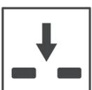
**Versione solo rientro IO**, disponibile solo per il modello a due funzioni SWV TH 2S-AWH. Questa variante è stata progettata per l'installazione in punti critici del tracciato in cui, per necessità progettuali, dev'essere evitata l'uscita d'aria. È opportuno ricordare che, usando la versione IO, lo sfiato non garantisce nessuna protezione contro le sovrappressioni causate dal riempimento della condotta.
