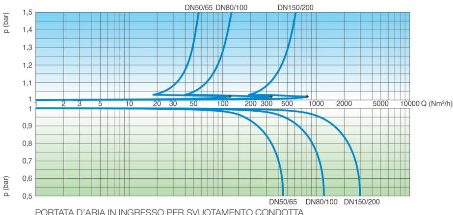
Le curve delle portate sono state ottenute in Kg/s, da prove di laboratorio e analisi numeriche, e convertite in Nm<sup>3</sup>/h applicando un fattore di sicurezza..
