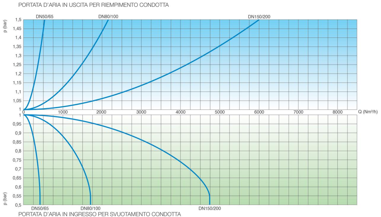
Le curve delle portate sono ottenute in Kg/s da prove di laboratorio e analisi numeriche, senza filtro, e convertite in Nm<sup>3</sup>/h applicando un fattore di sicurezza.
