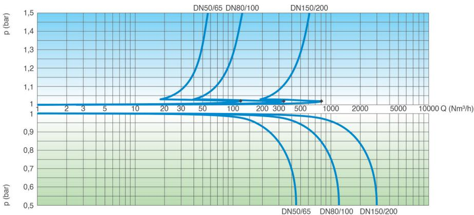
Las curvas de caudal se obtuvieron en Kg/s, a partir de pruebas de laboratorio y análisis numéricos, y se convirtieron a Nm<sup>3</sup>/h aplicando un factor de seguridad.
