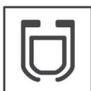
**Versión SWV 2S de dos funciones**, también llamado rompedor de vacío. Adecuado para lugares donde no se requiere la expulsión de las bolsas de aire acumuladas durante el funcionamiento. Se utiliza en los cambios de pendiente ascendentes y en los tramos ascendentes largos del perfil.
