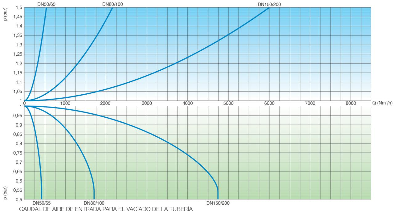
Las curvas de caudal se obtienen en Kg/s a partir de ensayos de laboratorio y análisis numéricos, sin filtrar, y se convierten a Nm<sup>3</sup>/h aplicando un factor de seguridad.
