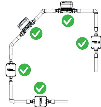
Fig. 1.4. posiciones de instalación posibles
