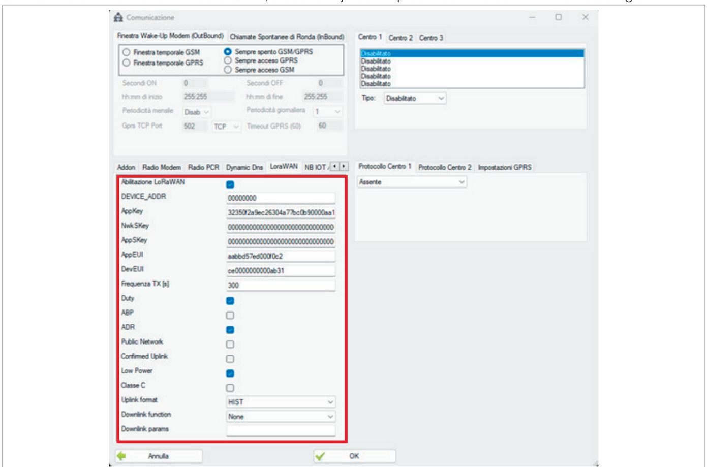
Fig. 8.44. Configuración de los parámetros de comunicación LoRa
