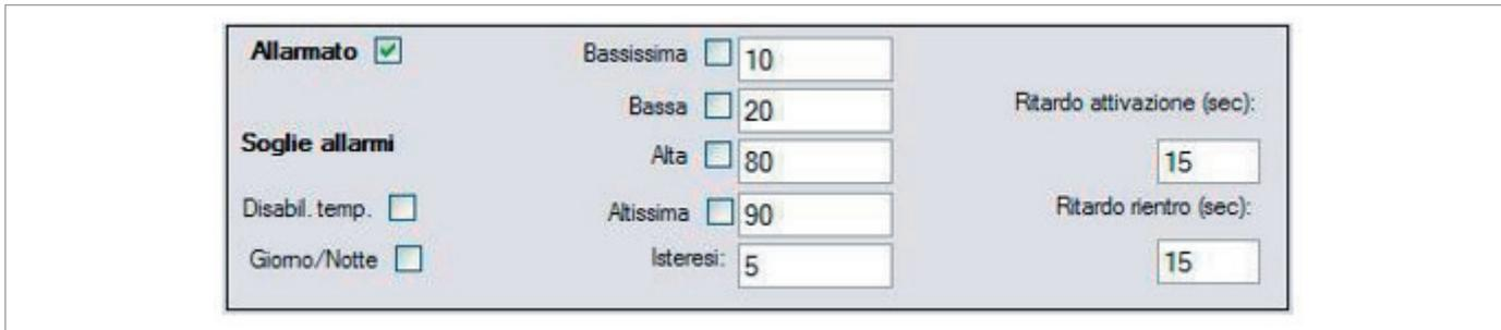
Fig. 8.38. Configuración de las alarmas en mediciones analógicas
