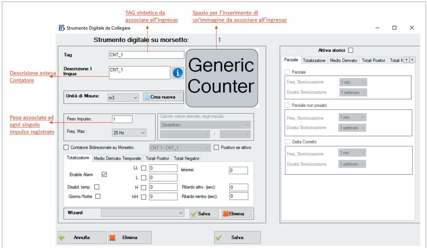
Fig. 8.27. Configuración del contador
