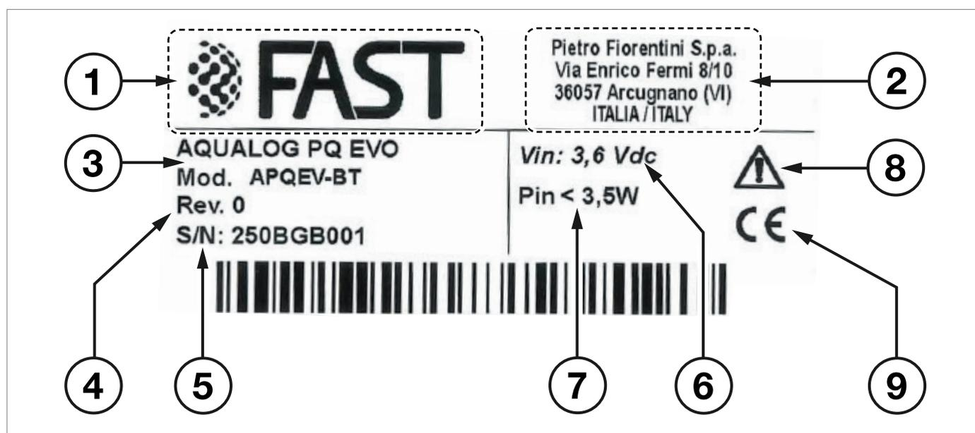
Fig. 2.1. Descripción de la placa de identificación
