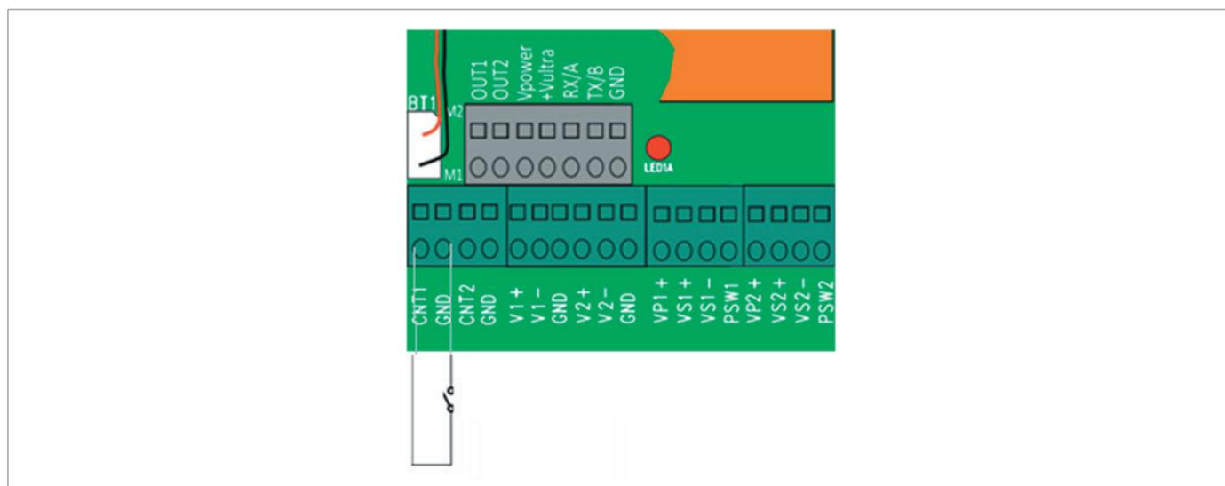
Fig. 4.5. Bloque de terminales de entradas digitales
