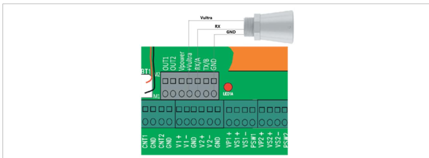
Fig. 4.6. Bloque de terminales de entrada digital
