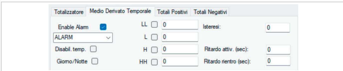
Fig. 8.41. Configuración de las alarmas de caudal derivadas de impulsos
