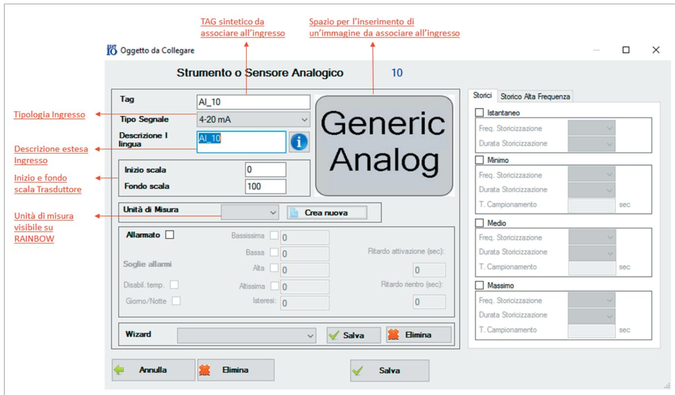
Fig. 8.25. Configuración de entrada analógica
