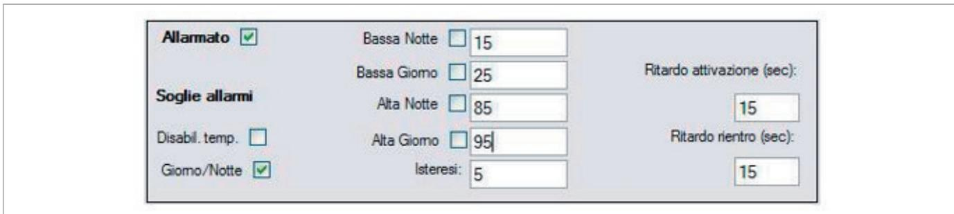
Fig. 8.39. Configuración de las alarmas en modo día/noche en mediciones analógicas
