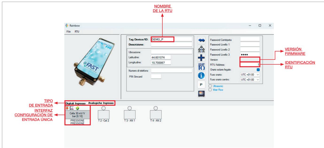
Fig. 8.23. Configuración RTU
