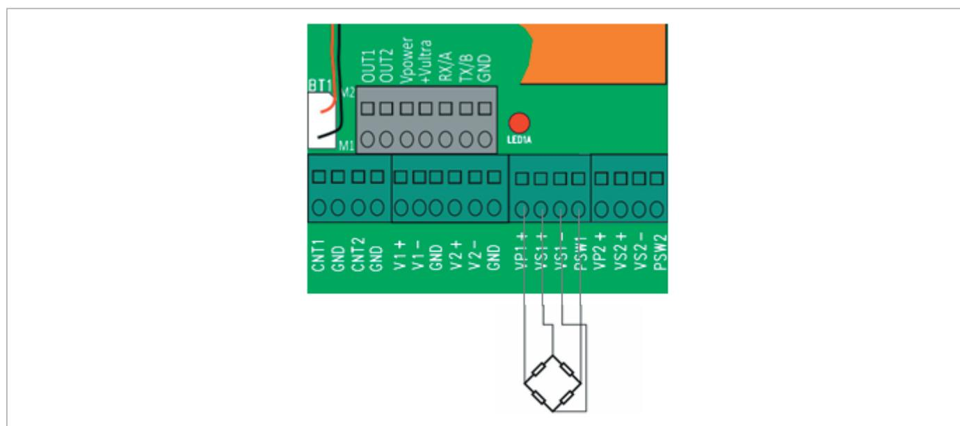
Fig. 4.4. Bloque de terminales de entradas de presión
