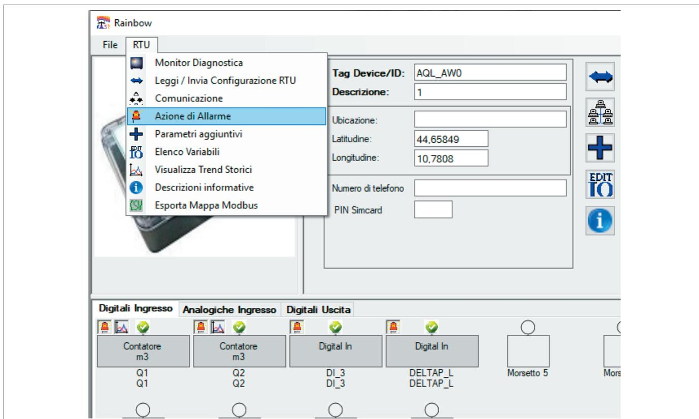
Fig. 8.48. Ventana de configuración de acciones de alarma
