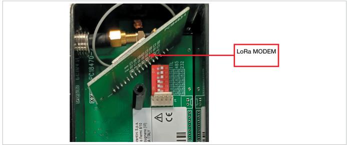
Fig. 8.45. LoRa Modem
