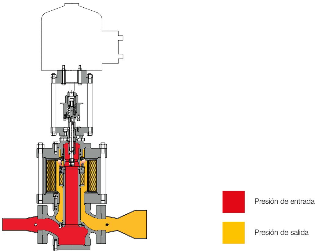
**Figura 6** Syncroflux con silenciador DB/819
