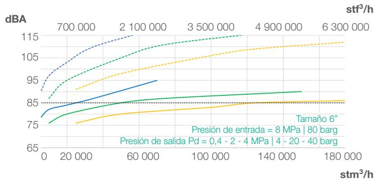
**Gráfico 1** Gráficos de eficiencia del silenciador Syncroflux
