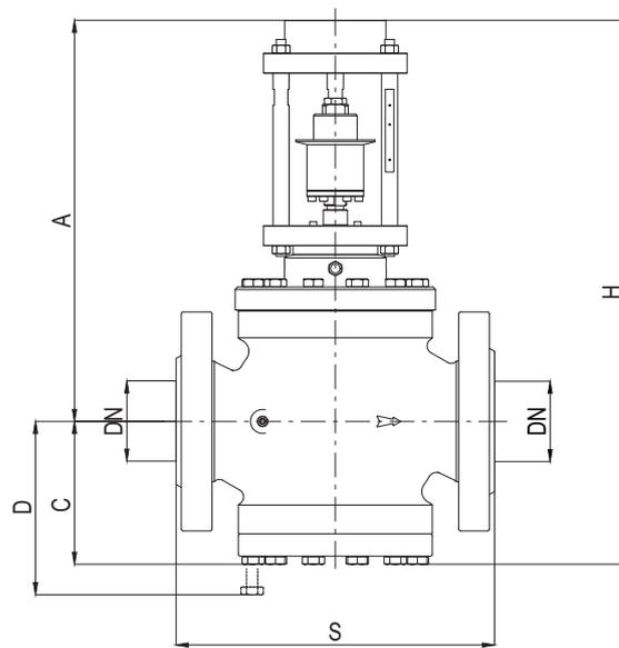
**Figura 9** Dimensiones de Syncroflux
