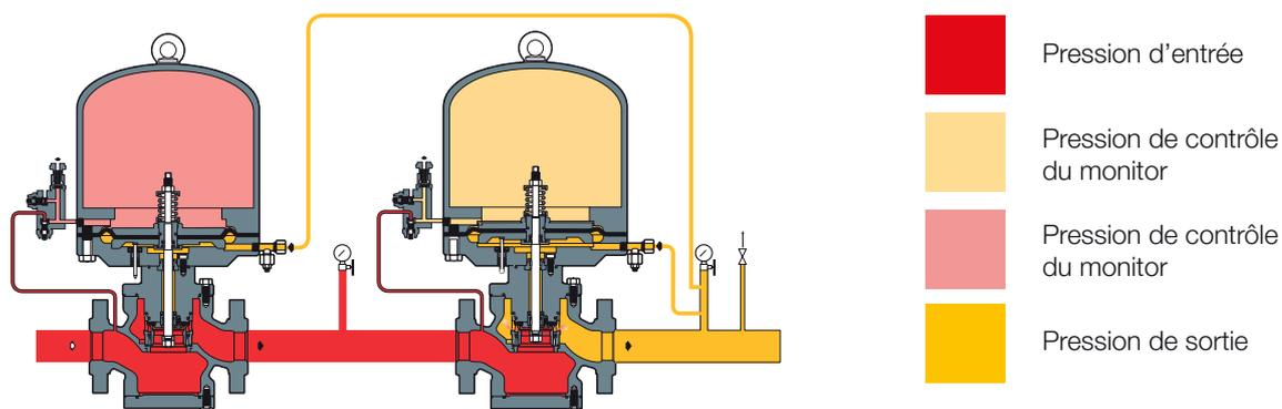
**Figure 5** Staflux 185 avec monitor en ligne
