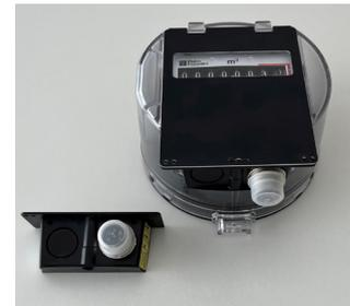
El indicador de Pietro Fiorentini utiliza un odómetro de 8 cifras y proporciona lecturas directas en metros cúbicos. El indicador tiene un grado de protección IP67. El indicador puede quitarse o instalarse con solo «un giro y un clic».
