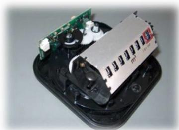
**Figura 4** Indicador con codificador óptico
