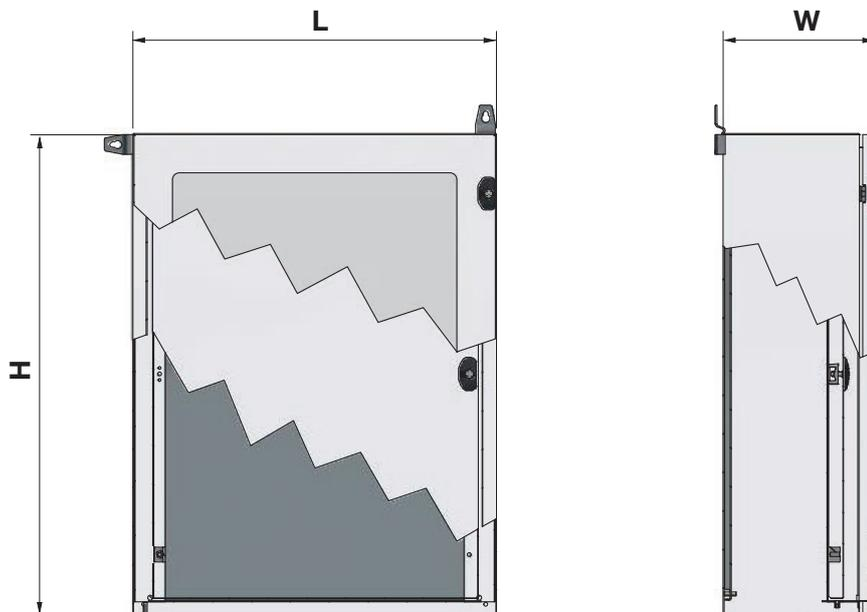
**Figura 9** Dimensioni GEDRA (modulo di interfaccia per aree sicure)
