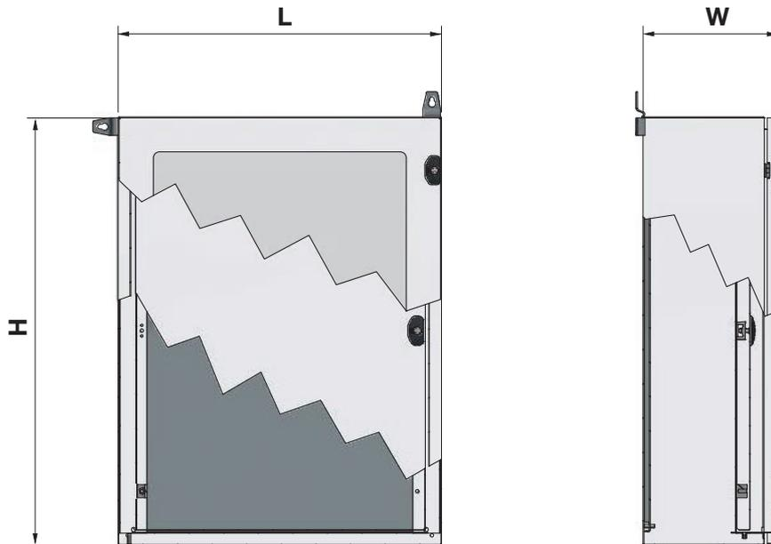
**Figura 9** Dimensiones (módulo de interfaz para zona segura) de GEDRA
