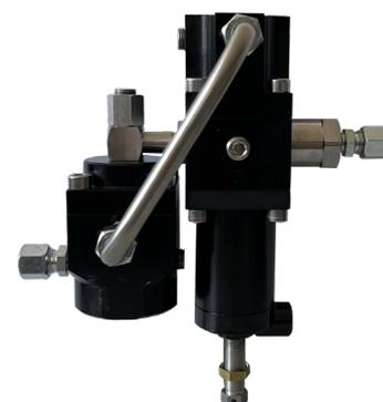
Il **pilota serie 200/A** è un dispositivo meccanico che consente di modificare il principio di funzionamento e il setpoint dei regolatori di pressione del gas pilotati. Il pilota è ottimizzato per migliorare la precisione e ridurre al minimo le prestazioni di chiusura.
