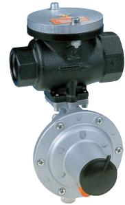
**Dilock** ist eine Sicherheitseinrichtung (auch als Sicherheitsabsperrentil bekannt), die den Gasstrom schnell unterbrechen kann, wenn der Druck einen voreingestellten Druck erreicht. Das Gerät wird hauptsächlich für Mittel- und Niederdruck-Gasverteilernetze eingesetzt. Der Dilock ist **wasserstofftauglich** für NG-H<sub>2</sub>-Mischungen.
