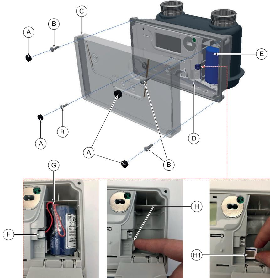
Fig. 9.9. Sostituzione della SIM
