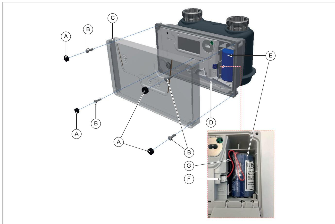
Fig. 9.8. Sostituzione del gruppo batteria di comunicazione
