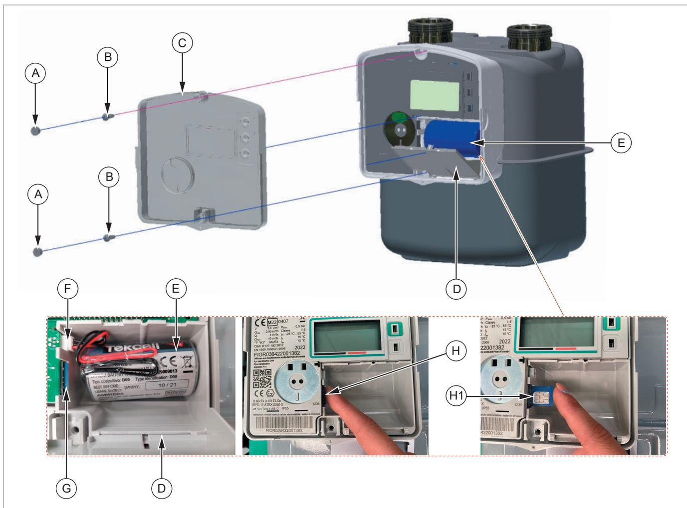
Fig. 9.11. Sustitución de la SIM
