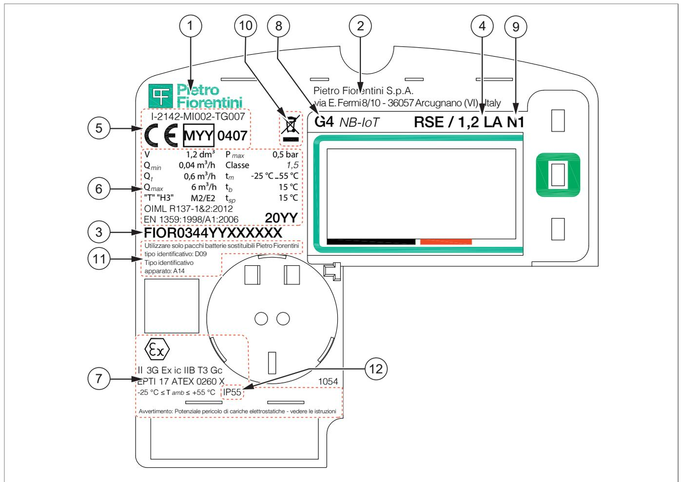
Fig. 2.1. Descripción de las placas de identificación
