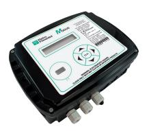
**Modus** gestisce fino a 2 canali PTZ, con ingressi separati per acquisizione di segnale impulsivo da misuratore primario, misura di di pressione e misura di temperatura. L'apparato dispone inoltre di ulteriori canali di ingresso per funzioni di monitoraggio esteso.
