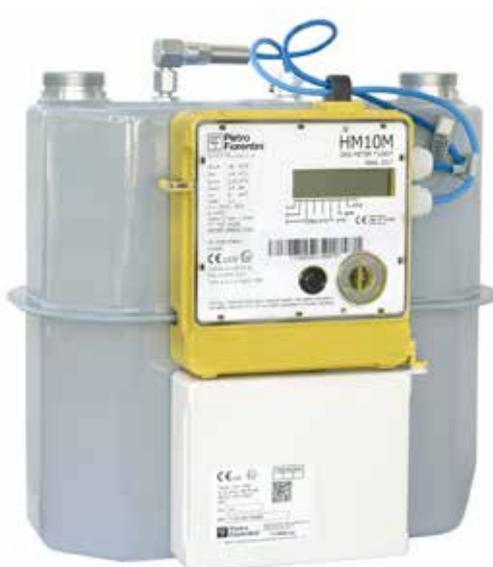
I contatori smart HyMeter per la misura commerciale sono dotati di sensori di temperatura e pressione per compensare il volume di gas misurato. Vengono principalmente utilizzati nelle reti dxsi distribuzione a bassa pressione del gas naturale.
