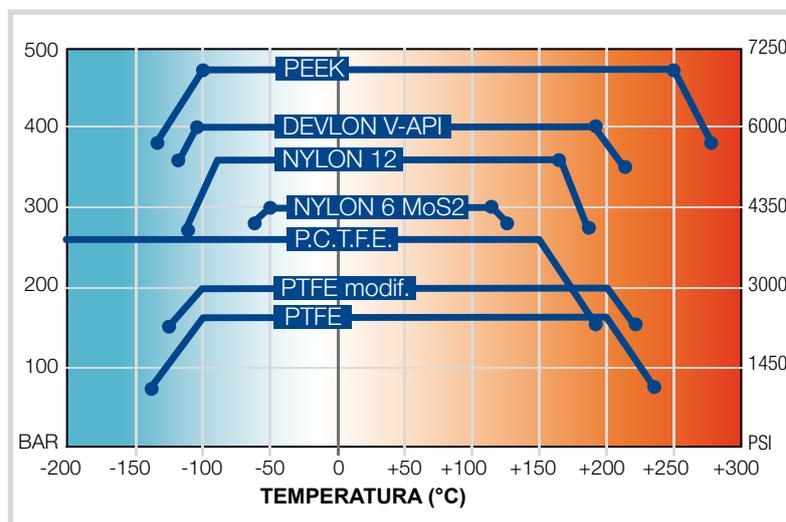
Diagramma pressione-temperatura per i materiali di tenuta della sede
