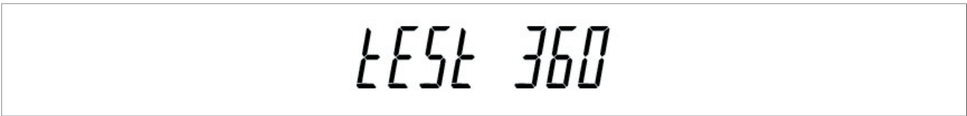
Fig. 5.7. Indicación del tiempo restante para la finalización de la prueba de estanqueidad
