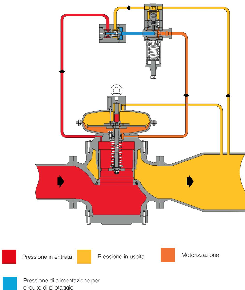
**Figura 10** Reval 182 con pilota fail-to-open serie 210
