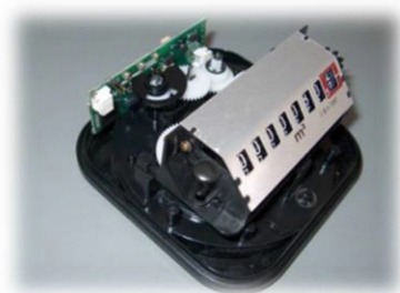
Figura 14 Indicatore encoder ottico
