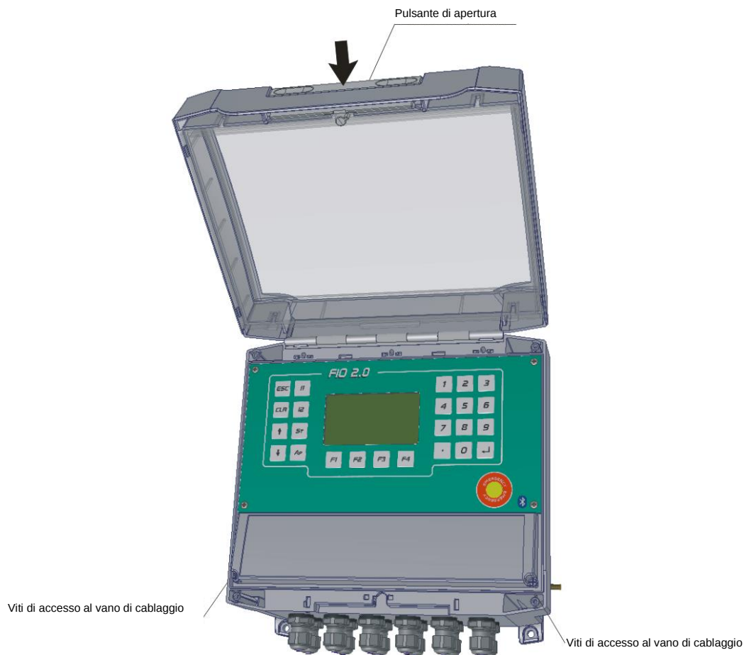
Figura 22 Accesso al vano di cablaggio
