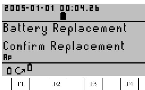
Figura 45 Conferma sostituzione: F1 per fermare il sistema
