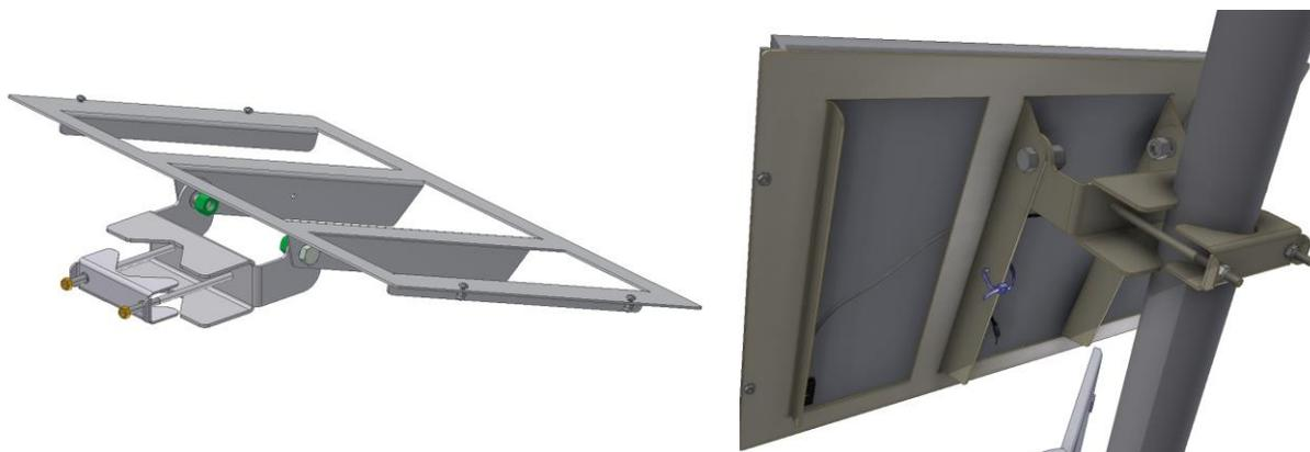
Fig. 10 – Struttura di Fissaggio del Pannello Solare
