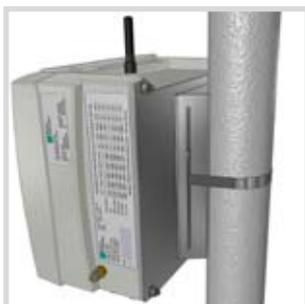
**Fio 2.2** instalación sobre columna a través placa de fijación orientable en vertical o horizontal
