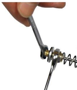
Per rimontare la valvola di blocco si possono eseguire in senso inverso le operazioni descritte per lo smontaggio. Prima di rimontare gli elementi di tenuta (anelli o-ring, membrane, ecc...), è necessario controllarne l'integrità ed eventualmente sostituirli.
